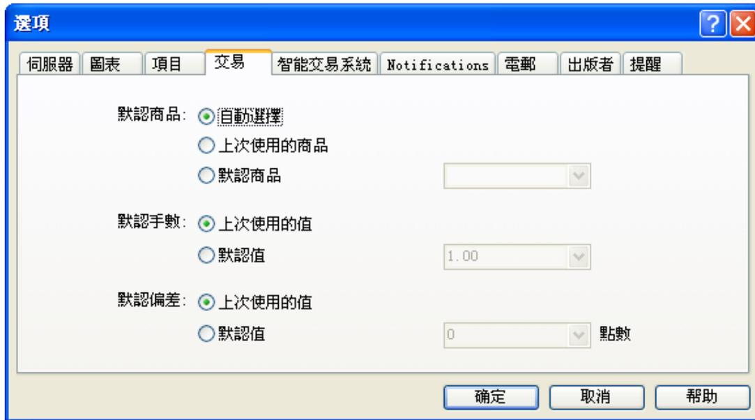
此選項用於設置打開交易定單視窗時的預設顯示內容。選中“上次使用的商品”意思是當建立一個頭寸時，最後一次交易的商品將被用作缺省商品。使用“默認商品”時，在未選中的下拉清單中選擇需要的商品名。用戶設置初始的偏差值與此方法相同，標誌“上次使用的值”允許使用上次交易的值，反之標誌“預設的偏差值”來設置永久的偏差值。
